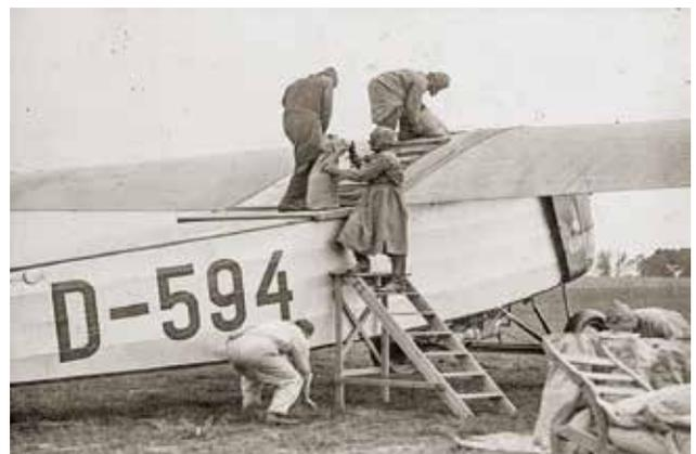
Abb. 18: Belademansschaft am Flugzeug vom Typ Fokker-Grulich FII der Luft Hansa Hamburg.
