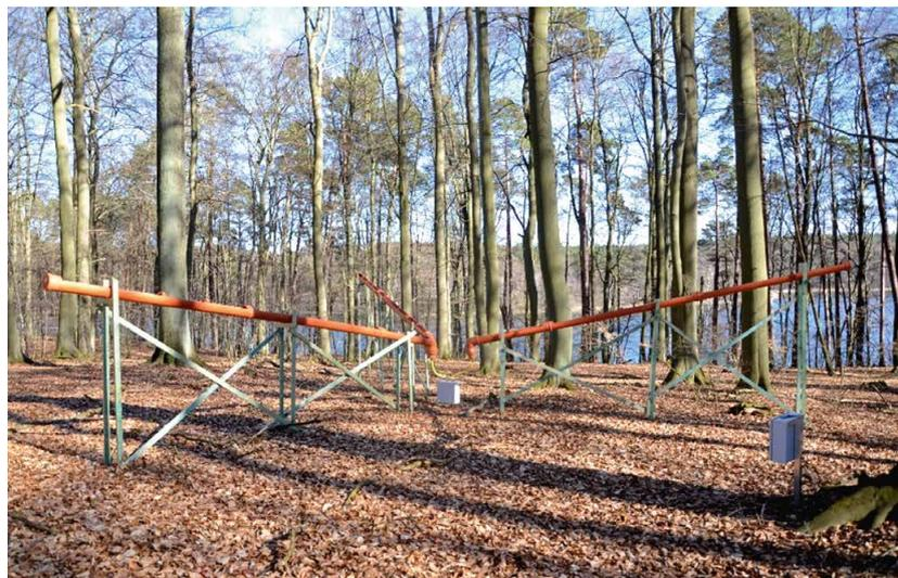
Abb. 3: Rinnensystem für die Messung des Kronendurchlasses und experimentelles Design mit fünf Rinnensystemen bestehend aus je drei Rinnen (Foto: GFZ)
