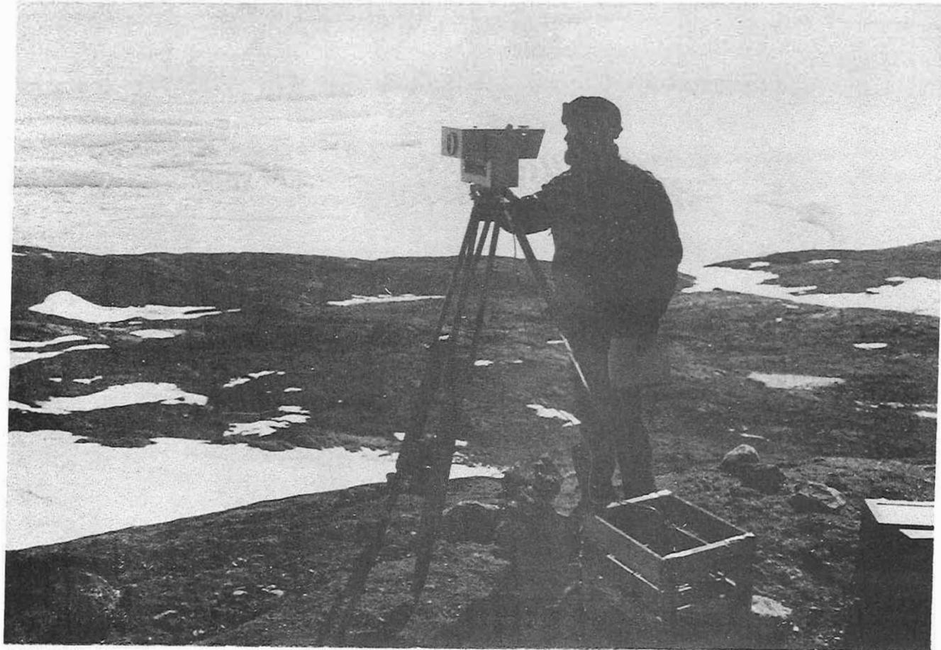
Abb. 3. Elektrooptisches Entfernungsmeßgerät EOK 2000 des VEB Carl Zeiss Jena im Einsatz während der 17. SAE (Foto: Dr.-Ing. K. DRESSLER)
