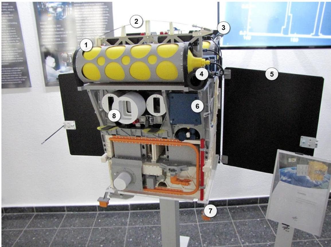
Abb. 1: Duplikat des BIROS-Satelliten beim DLR in Berlin-Adlershof: (1) Treibstofftank, (2) Antenne zur Kommunikation mit dem mitgeführten Cube-Sat, (3) Sternenkamera zur Positionsbestimmung, (4) Optisches System zur Beobachtung des Cube-Sat, (5) Solararrays, (6) Startbox für den Cubesat, (7) Sonnensensor für Orientierung im Orbit, (8) dreigliedriges Sensorsystem zur Feuerbeobachtung. (Foto: Dierk Spreen)
