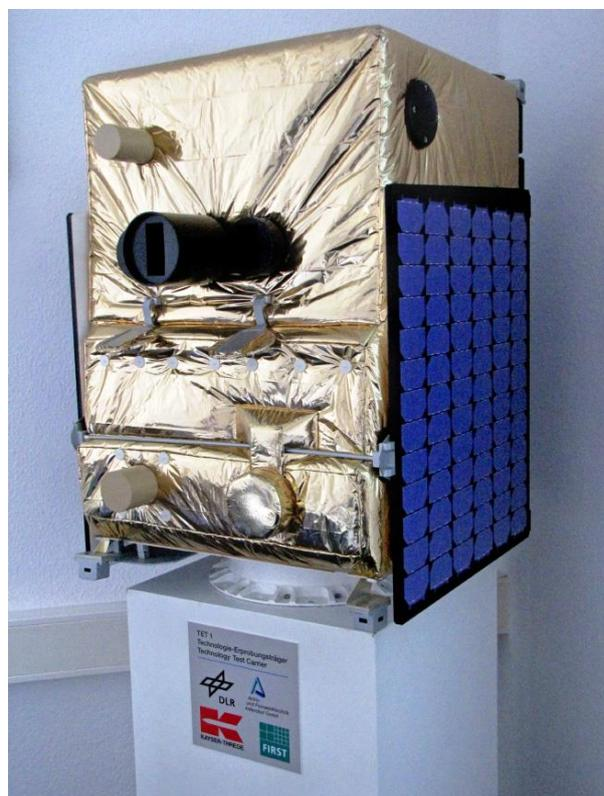
Abb. 4: Blick auf ein Duplikat des Satelliten TET-1 bei der Astro- und Feinwerktechnik GmbH. „TET“ steht für „Technologie-Erprobungs-Träger“, da der Hauptzweck des Satelliten die Erprobung von Technologien im Orbit war. Die Bordkamera ist baugleich mit dem BIROS-Sensorsystem. Auf dem Bild sind die Solararrays (blau) nicht entfaltet, aber die goldene Superisolation ist sehr gut sichtbar. (Foto: Dierk Spreen)
