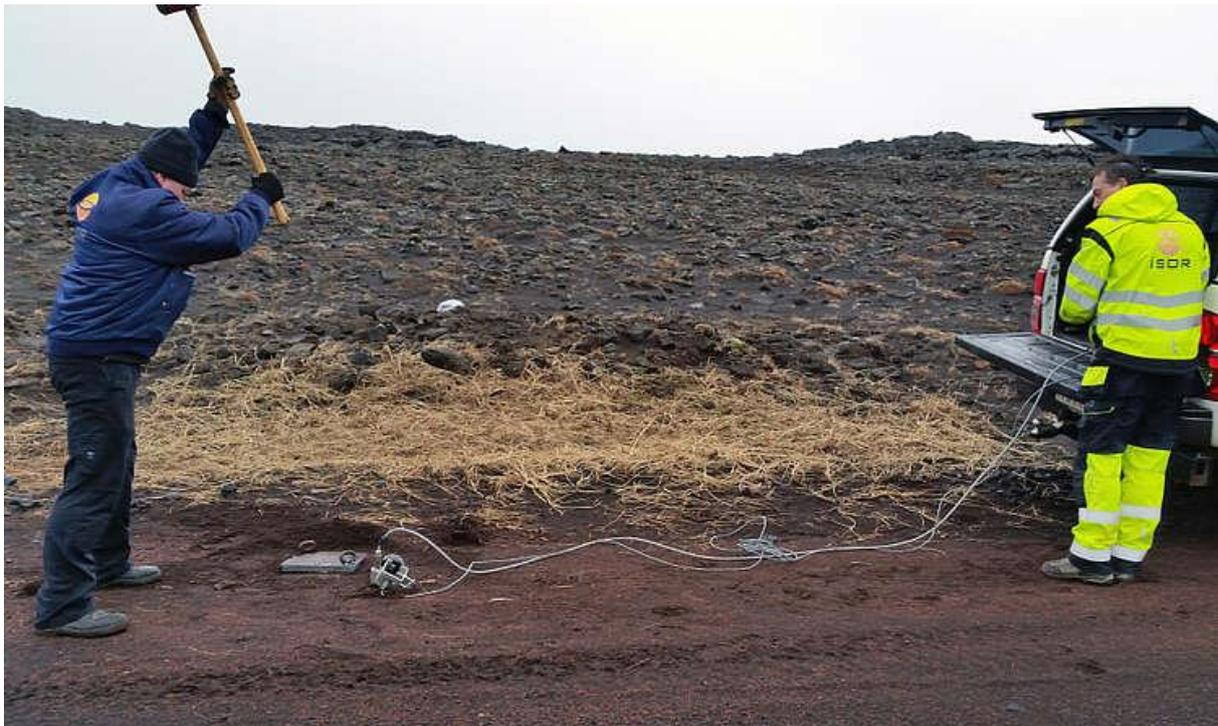
Abb. 2: GFZ-Wissenschaftler im Feldeinsatz in Island: Durch die aktive seismische Anregung mit einem Hammerschlag wird das vergrabene Glasfaserkabel lokalisiert. (Foto: P. Jousset/GFZ)
