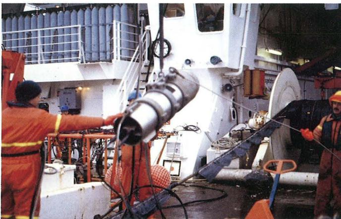
Abb. 3: Die 32 l-Airgun als seismische Quelle.
