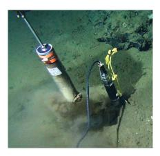
Messungen des Wärmeflusses im Meeresboden. Mithilfe des Forschungs-U-Boots ALVIN untersuchten Forschende den Energieumsatz im Sediment vor der US-amerikanischen Westküste. (Aufnahme: Geoff Wheat, NSF OCE 1130146, and the National Deep Submergence Facility)
