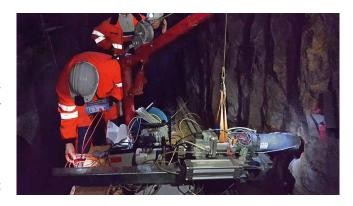
Validierungstest von seismischen Quellen im GFZ-Untertagelabor (Foto: T. Dickmann, Amberg Technologies AG)
