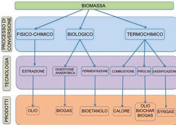
La pirolisi, processo ancora sperimentale, sfrutta una conversione della biomassa, con umidità inferiore al 15%, effettuata in ambiente completamente privo di ossigeno e ad alte temperature (tra 200 e 700 °C); la tecnologia più promettente sembra essere la flash pirolisi, condotta a temperature sui 650 °C e tempi di permanenza della biomassa estremamente brevi (1-2 secondi) che consentono di ottenere un prodotto liquido detto bio-olio o
