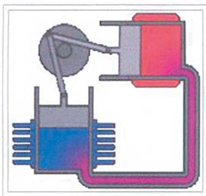
Può funzionare con qualsiasi tipo di sorgente di calore, ad esempio con calore solare concentrato oppure con calore fornito da una caldaia di combustione di biomassa legnosa, carbone, biogas, gas e/o combustibili liquidi. Ad oggi sono poche le applicazioni pratiche di questa tecnologia. Fra queste ritroviamo l'impianto realizzato a Castel d'Aiano (BO) dal Centro Innovazione per la Sostenibilità Ambientale (CISA) di Porretta Terme (BO).
