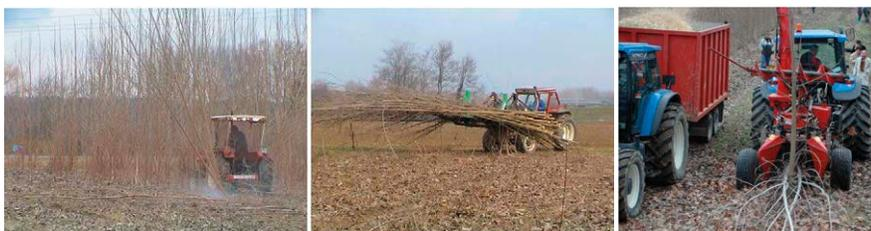
La tendenza che si sta registrando in Italia nel mercato delle macchine per la raccolta è lo sviluppo di macchine, in genere, più economiche e leggere. Con questa tipologia, inoltre, si riescono a tagliare piante con diametri superiori ai 10 cm, fatto che consente di gestire anche impianti impostati con turni di ceduzione più ampi. Il prodotto raccolto con questa macchina può essere sia cippato che pezzato.
