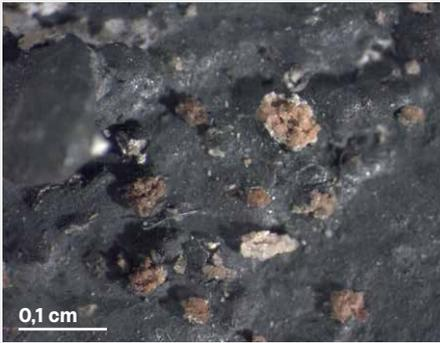
**Abb. 5.9** Detail Schadensbild (Stereomikroskop). In der Malschicht haben sich kraterartige Öffnungen gebildet, durch die dunkelbraunes, hellbraunes und weisses Material in Form von losen Konglomeraten austritt.
