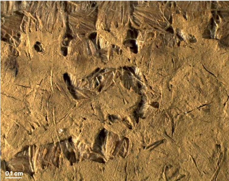
**Abb. 2.11** Detail Schwundrisse (Stereomikroskop).
