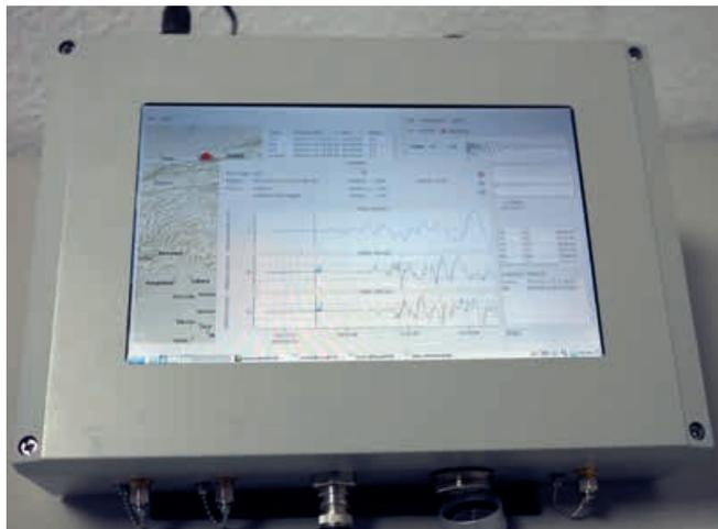
Abb. 3: MPwise-Einheit mit einer Demonstration der DOSEW-Software (Parolai et al., 2015)
